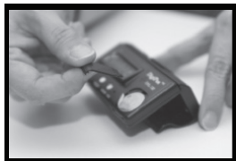
Vor dem ersten Gebrauch den Schutzstreifen entfernen, um die Batterie zu aktivieren.
