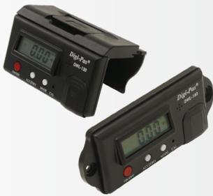
DWL 130 & DWL 180 sind digitale Module mit einer Auflösung von 0,05° die in erster Linie für benutzerdefinierte Anwendungszwecke entworfen wurden. Sie können an konventionellen Wasserwaagen angebracht werden um diese SOFORT in hochpräzise Digitalwasserwaagen umzuwandeln.
