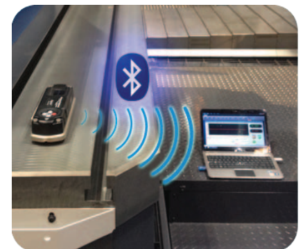
Digi-Pas® 2-Achsen Geradheitsmessung Unter Verwendung von fortschrittlicher digitaler MEMS-Technologie
